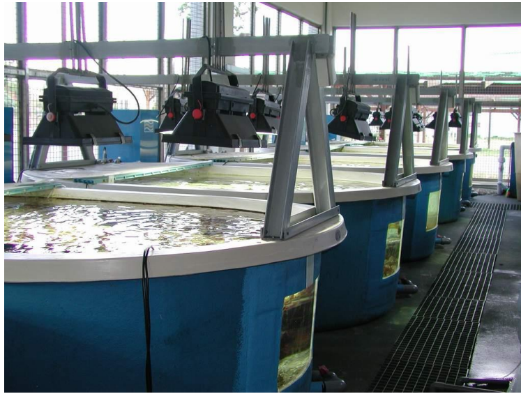
圖 3. 模擬墾丁珊瑚礁生態系之中觀生態池系統
